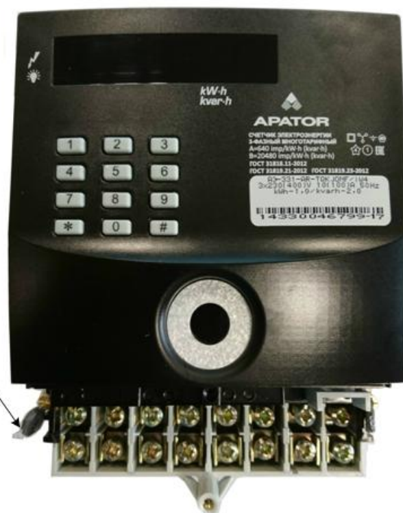
Рисунок 3 - Место установки пломбы с оттиском знака поверки
