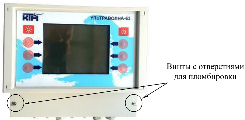
Рисунок 3 - Схема пломбировки вычислительного блока «КТМ Ультраволна 63 С» от несанкционированного доступа
