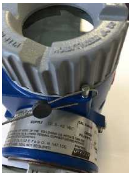
Рисунок 4 - Пломбировка преобразователей давления измерительных моделей IMV25, IMV30, IMV31
