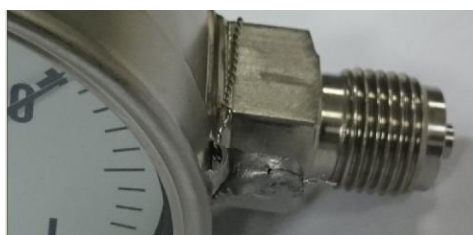
Рисунок 5 - Пример пломбирования манометров продеванием контровочной проволоки и навешивания свинцовой или пластиковой пломбы.
