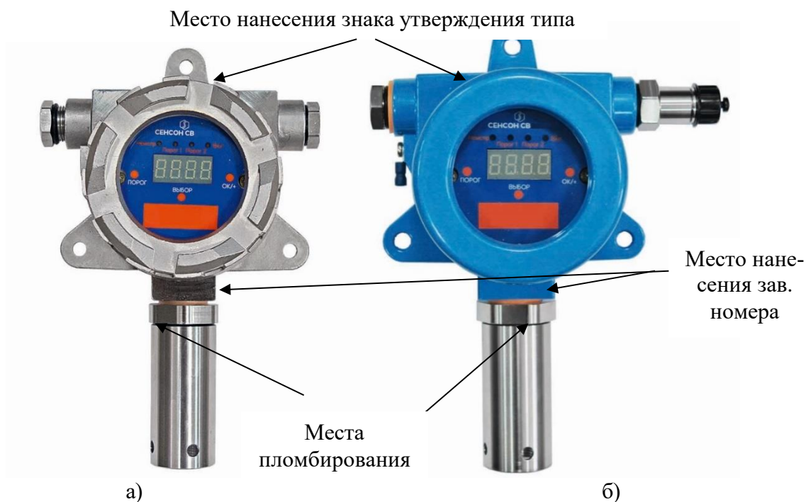
Рисунок 4 - Общий вид газоанализатора, модель «Сенсон-СВ»: а) исполнение 5031 в корпусе из нержавеющей стали; б) исполнение 5031 во взрывозащищенном корпусе из алюминиевого сплава
