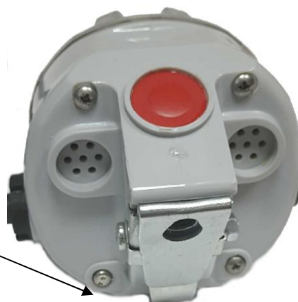
Рисунок 2 - Сигнализаторы метана и окиси углерода Сигмет-2, совмещенные со светильником СВГ Луч-4, место нанесения знака утверждения типа и пломбирования от несанкционированного доступа посредством установки специального винта
