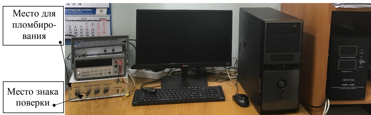
Рисунок 2 - Общий вид электронных блоков УКММ, схема пломбировки от несанкционированного доступа и обозначение места нанесения знака поверки
