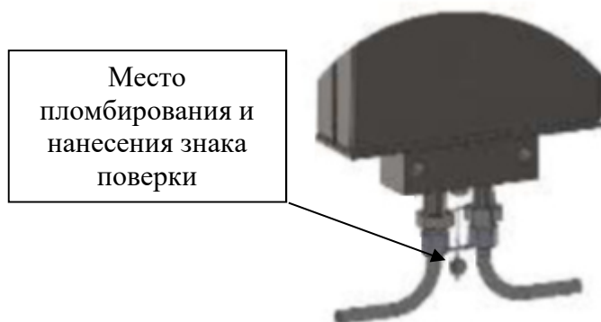
Рисунок 2 – Место пломбирования и нанесения знака поверки на расходомер массовый TSERUS
