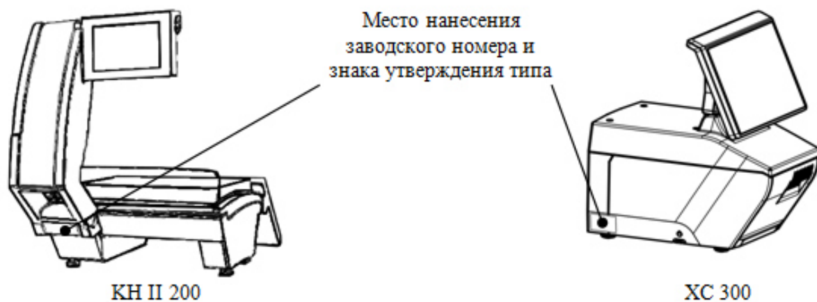
Рисунок 14 – Место нанесения заводского номера и знака утверждения типа весов исполнений KN II 200, XC 300
