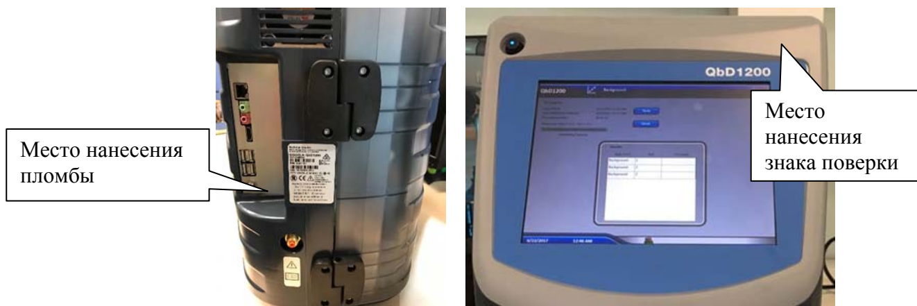
Рисунок 2 - Схема пломбировки от несанкционированного доступа, обозначение места нанесения знака поверки
