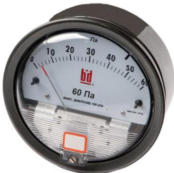
Рисунок 1 - Общий вид манометров, отградуированных в Па
