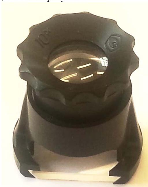
Рисунок 1 - Общий вид луп измерительных ЛИ-3-10<sup>x</sup>
