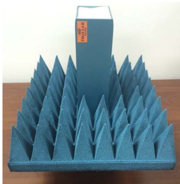
Рисунок 3 - Внешний вид антенны-зонда ТМАЗ 1-2 И диапазона частот 1 - 2 ГГц (слева), внешний вид антенны-зонда ТМАЗ 2-4 И диапазона частот 2 - 4 ГГц (справа)
