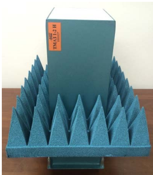
Рисунок 3 - Внешний вид антенны-зонда ТМАЗ 1-2 И диапазона частот 1 - 2 ГГц (слева), внешний вид антенны-зонда ТМАЗ 2-4 И диапазона частот 2 - 4 ГГц (справа)
