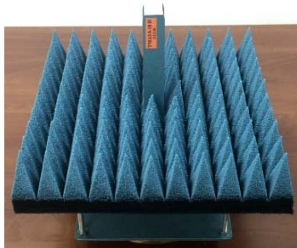
Рисунок 4 - Внешний вид антенны-зонда ТМАЗ 4-8 И диапазона частот 4 - 8 ГГц (слева), внешний вид антенны-зонда ТМАЗ 8-18 И диапазона частот 8 - 18 ГГц (справа)
