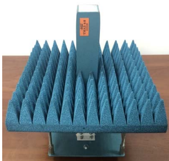
Рисунок 4 - Внешний вид антенны-зонда ТМАЗ 4-8 И диапазона частот 4 - 8 ГГц (слева), внешний вид антенны-зонда ТМАЗ 8-18 И диапазона частот 8 - 18 ГГц (справа)
