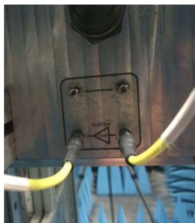
Рисунок 5 - Внешний вид антенны-зонда ТМАЗ 18-40 И диапазона частот 18 - 40 ГГц (слева), внешний вид усилителя мощности (справа)
