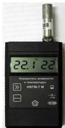
Рисунок 21 - Общий вид измерителя ИВТМ-7 М исполнения ИВТМ-7 М 2
