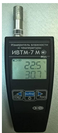
Рисунок 29 - Общий вид измерителя ИВТМ-7 М исполнения ИВТМ-7 М 6-1
