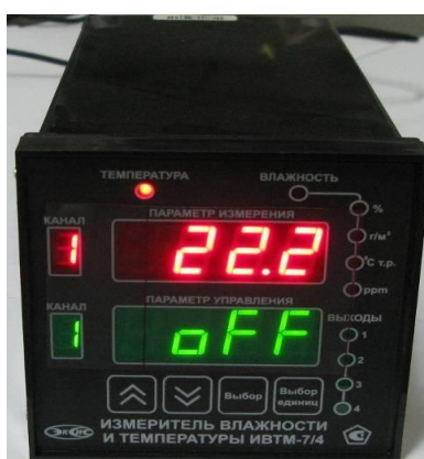
Рисунок 41 - Общий вид измерителя ИВТМ-7 /X исполнения ИВТМ-7 /X-Щ2
