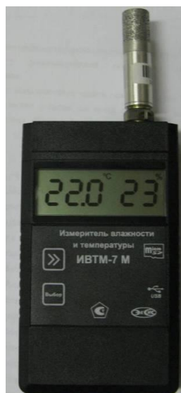
Рисунок 28 - Общий вид измерителя ИВТМ-7 М исполнения ИВТМ-7 М 6
