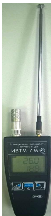
Рисунок 26 - Общий вид измерителя ИВТМ-7 М исполнения ИВТМ-7 М 4-1
