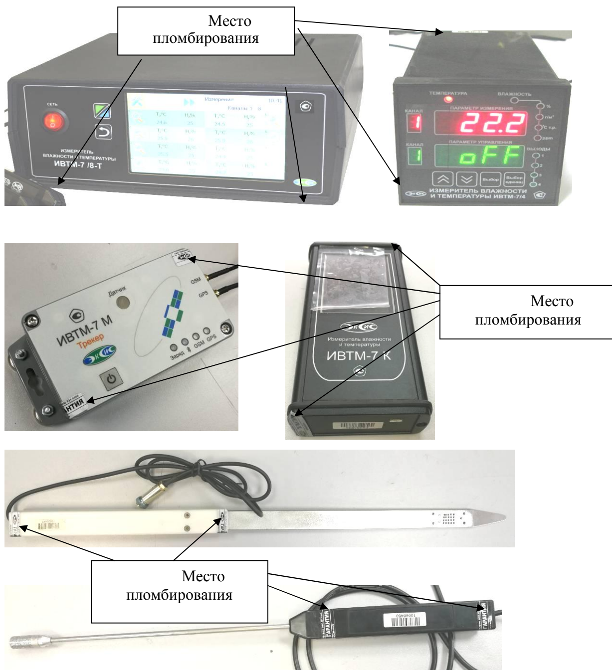
Рисунок 56 - Схема пломбирования измерителей от несанкционированного доступа (Стрелками указаны места пломбирования от несанкционированного доступа)
