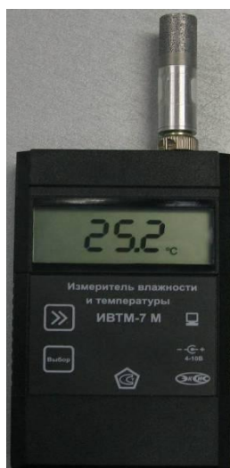
Рисунок 20 - Общий вид измерителя ИВТМ-7 М исполнения ИВТМ-7 М 1
