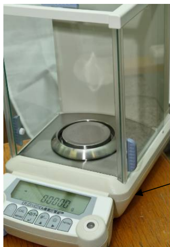
Рисунок 3 - Обозначение места нанесения знака поверки весов
