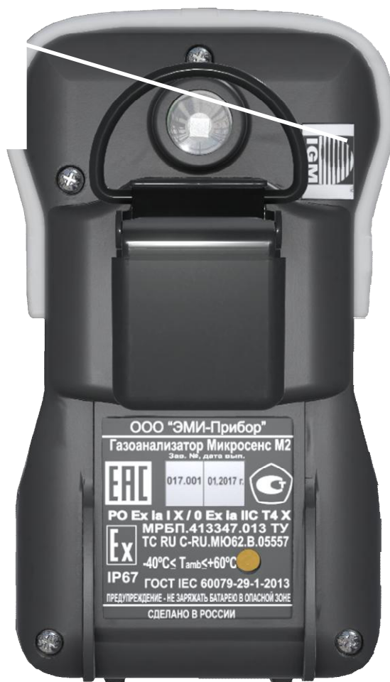
Рисунок 2 - Схема пломбировки от несанкционированного доступа
