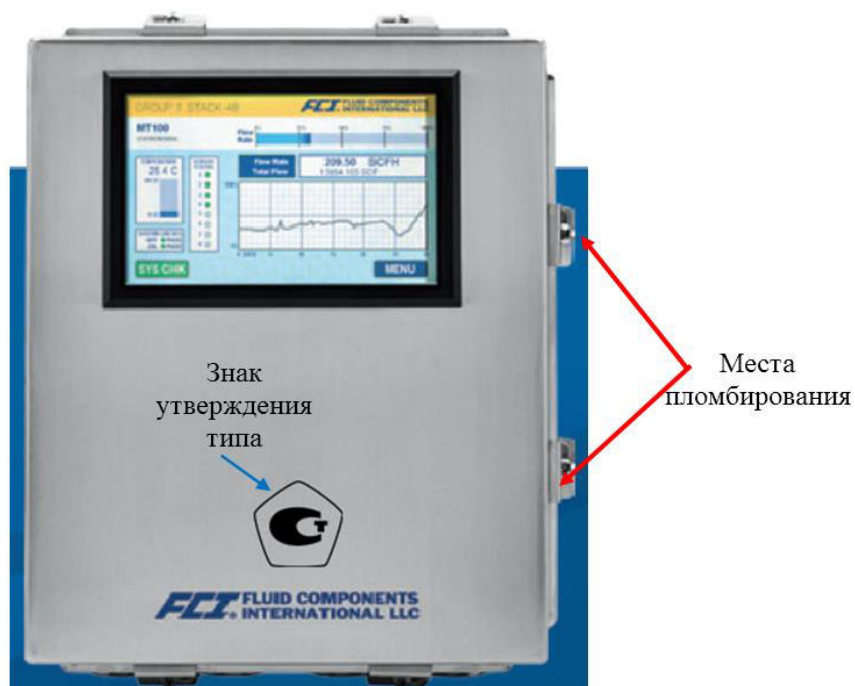
Рисунок 1 – Схема пломбировки и место нанесения знака утверждения типа вторичного преобразователя расходомера газа МТ100М
