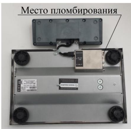
пломбировочная чашка устанавливается
