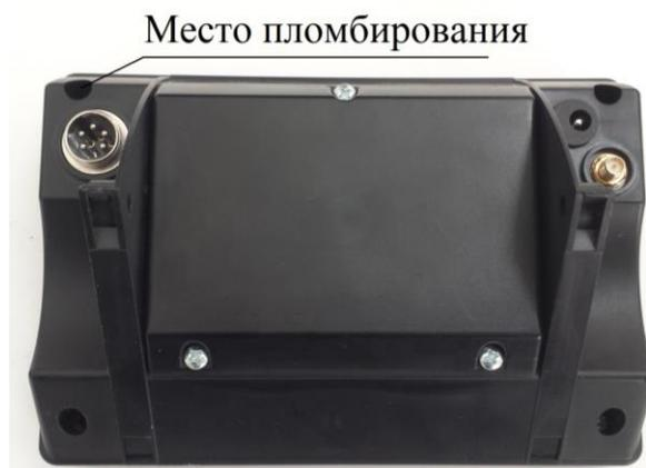
пломбировочная чашка устанавливается
