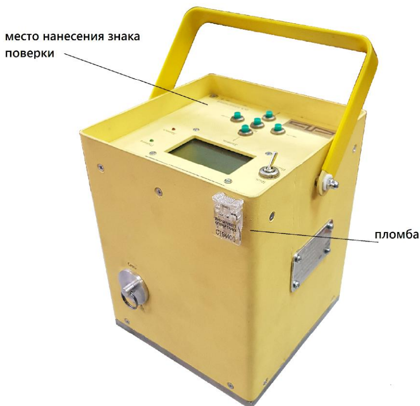
Рисунок 2 – Схема пломбировки от несанкционированного доступа и обозначение места нанесения знака поверки
