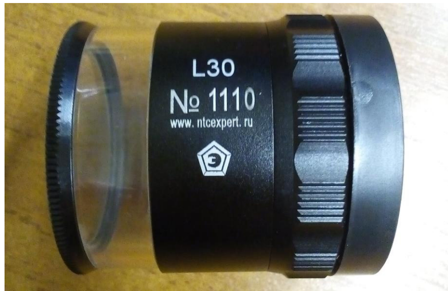
Рисунок 1 - Общий вид лупы измерительной ЛИ-3-10 × с подсветкой (L 30)
