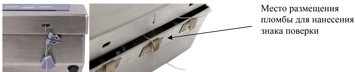
Рисунок 3 – Место размещения пломбы для нанесения знака поверки при пломбировании терминала IND570
