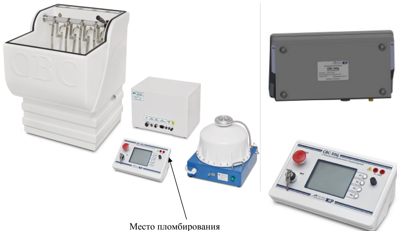
Рисунок 1 – Внешний вид и схема пломбирования стендов
