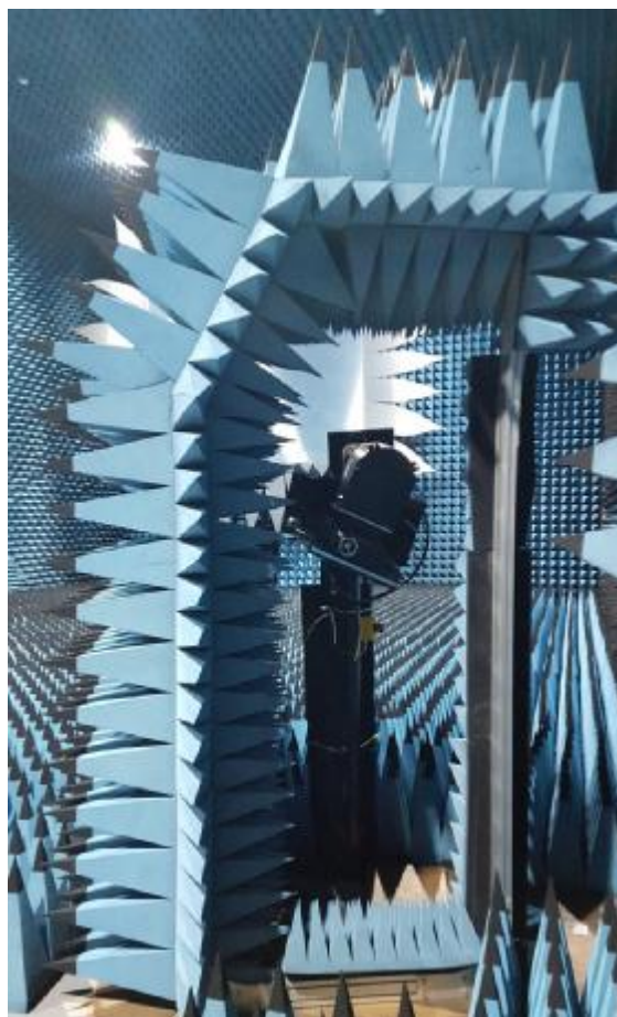
Рисунок 3 - Внешний вид ОПУ облучателя зеркала радиоколлиматора и его укрытия
