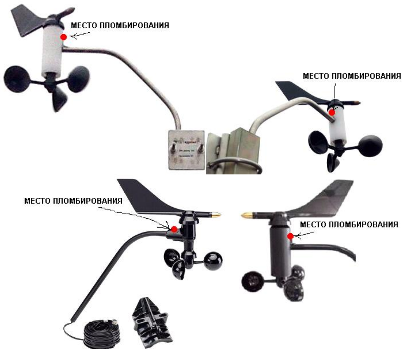
Рисунок 1 - Общий вид датчика ветра магнитоэлектрического ДВМ-6410
