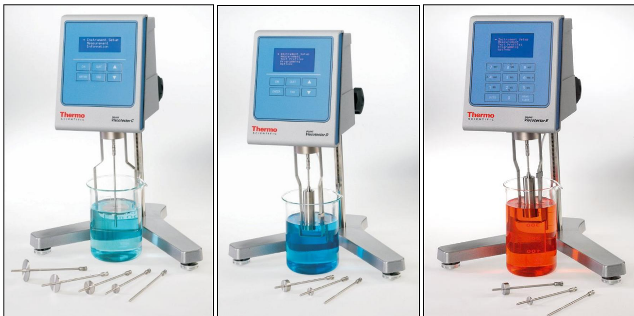
Рисунок 2 – Общий вид вискозиметров ротационных НААКЕ модификаций Viscotester C версий L и R, Viscotester D версий L и R, Viscotester E версий L и R
