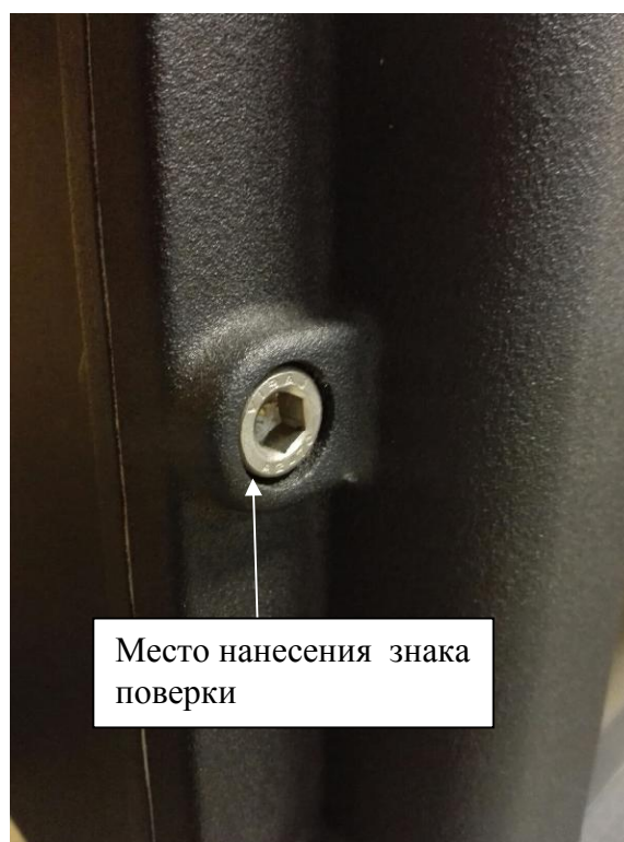
Рисунок 2 - Место пломбировки от несанкционированного доступа и нанесения знака поверки в виде оттиска поверительного клейма
