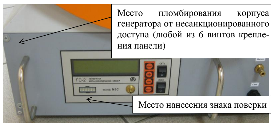
Рисунок 2 - Схема пломбирования корпуса генератора от несанкционированного доступа, обозначение места нанесения знака поверки
