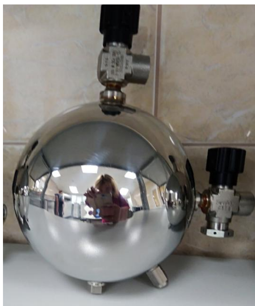
Рисунок 1 - Общий вид пикнометра напорного ARCCO ANUBIS
