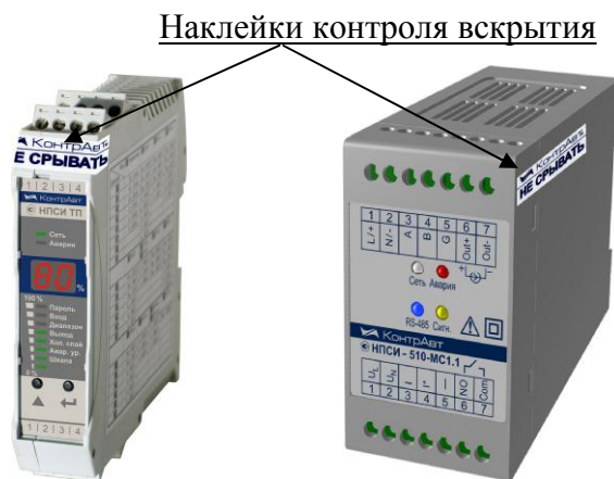
Рисунок 2 – Схема пломбировки от несанкционированного доступа с наклейками контроля вскрытия
