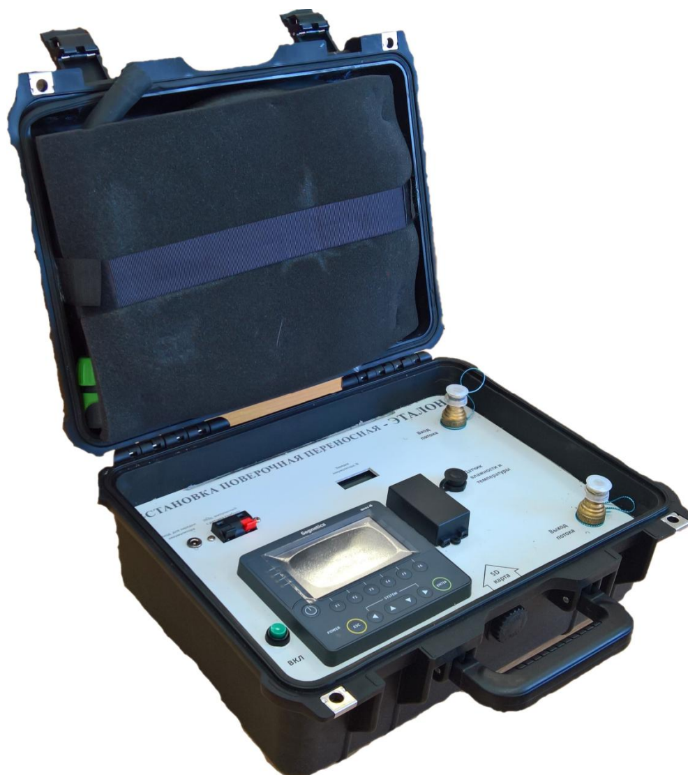
Рисунок 1 – Общий вид установок поверочных переносных Эталон
