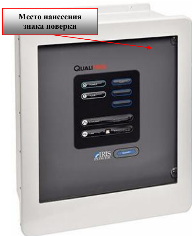
Рисунок 3 - Общий вид блока обработки и сбора данных, включая измеритель ЧР, системы PDTracII
