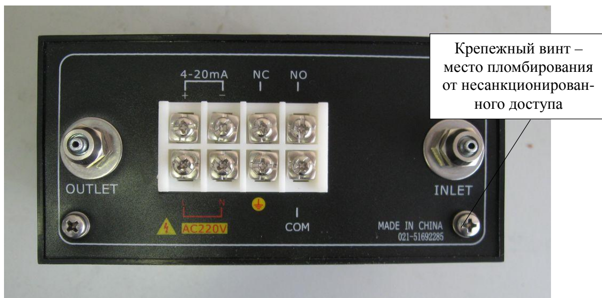
Рисунок 2 – Схема пломбирования газоанализаторов (на примере GNL-2100)
