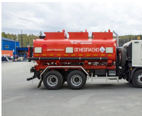
Рисунок 3 - Общий вид АТЗ с тремя секциями
