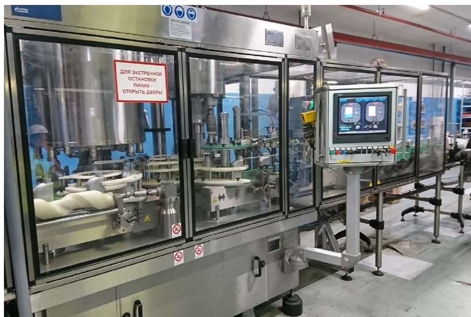
Рисунок 1 – Общий вид дозатора весового дискретного действия АСМА, встроенного в комплексную линию розлива и упаковки смазочных масел
