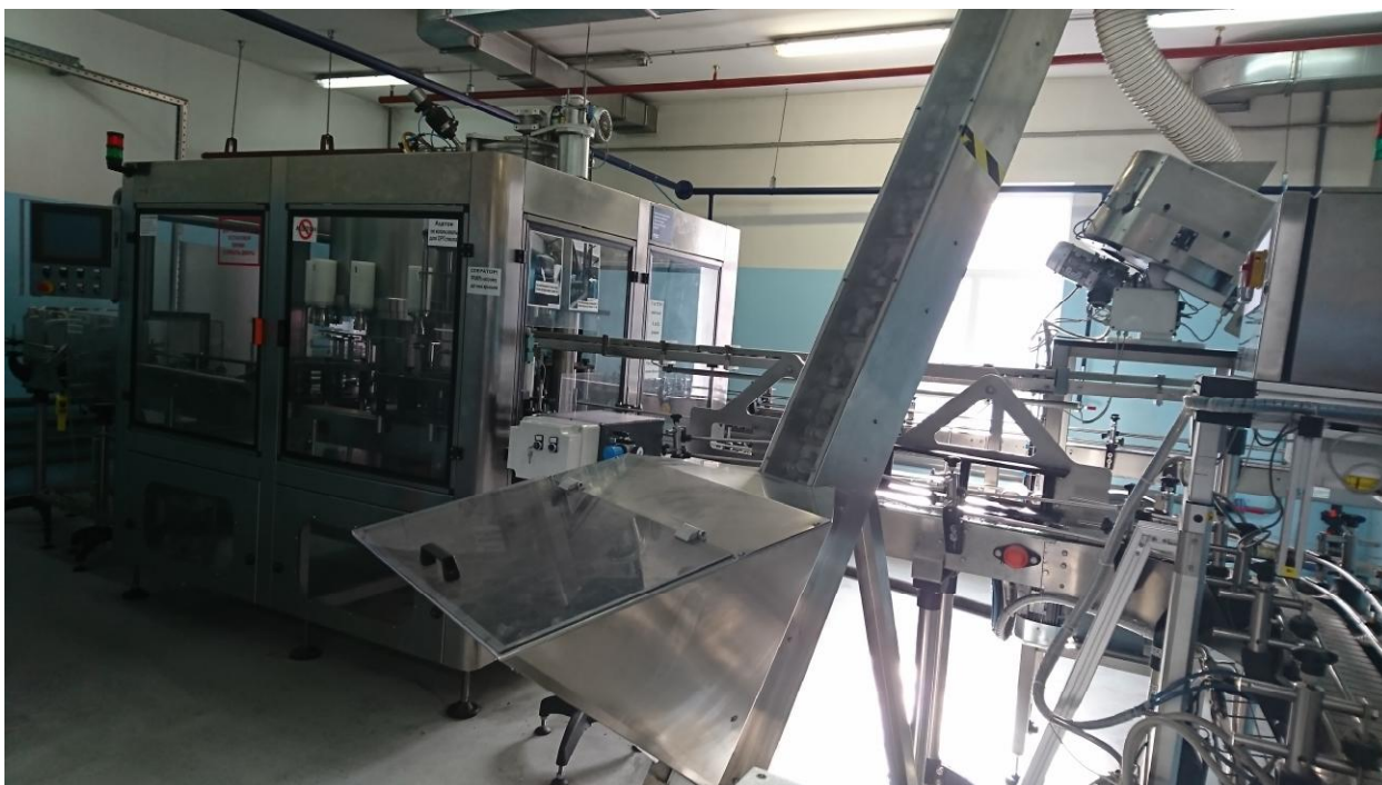
Рисунок 1 - Общий вид дозатора, встроенного в комплексную линию розлива и упаковки смазочных масел
