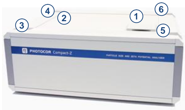
Рисунок 1 - Внешний вид анализатора модификации Photocor Complex и схема его пломбировки от несанкционированного доступа
