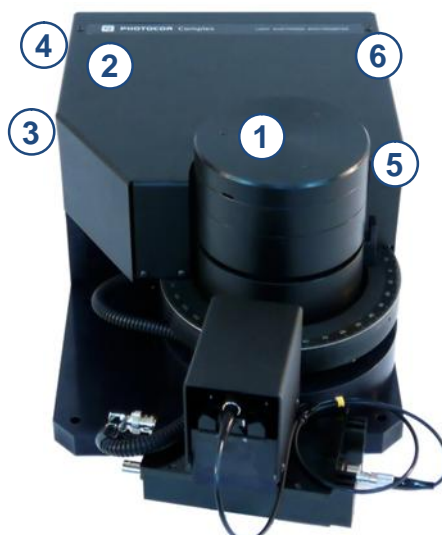
Рисунок 1 - Внешний вид анализатора модификации Photocor Complex и схема его пломбировки от несанкционированного доступа
