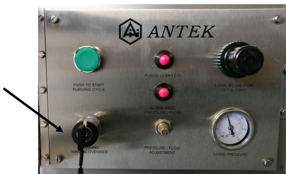
Рисунок 2 – Общий вид блока продувки (стрелкой отмечен ключ защиты от несанкционированного вскрытия корпуса)
