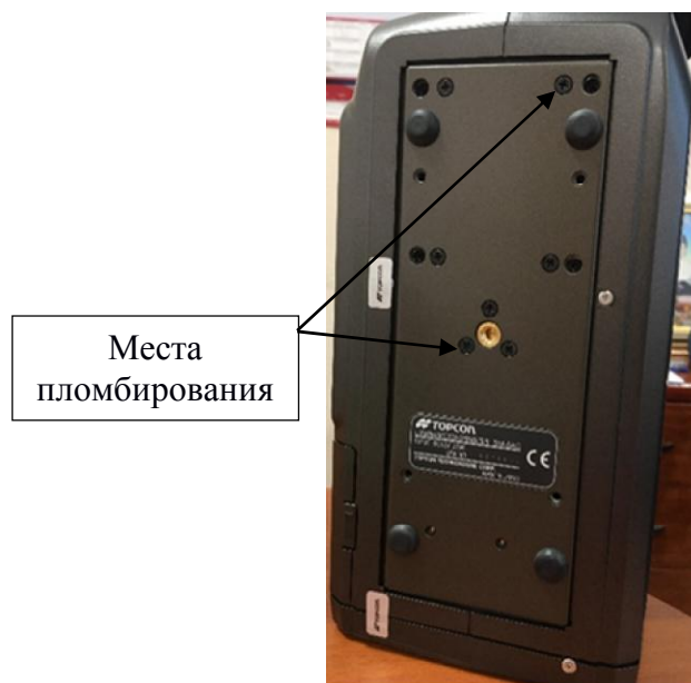
Рисунок 2 - Схема пломбировки от несанкционированного доступа
