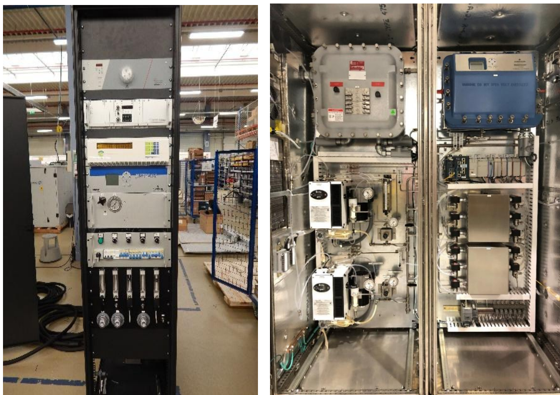
Рисунок 2 - Внешний вид системы модификации Rosemount CEMS CD
