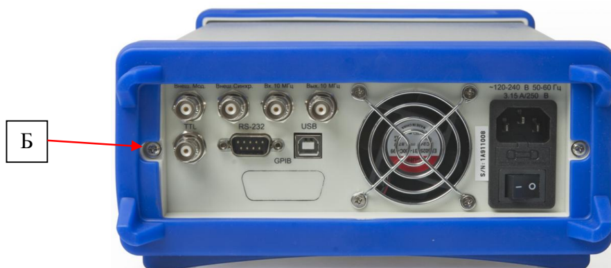
Рисунок 2 – Вид задней панели генераторов и схема пломбировки от несанкционированного доступа (Б)
