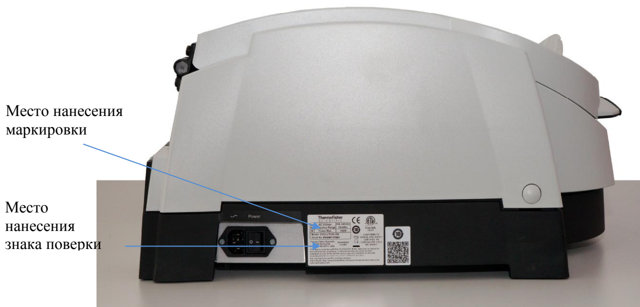
Рисунок 2 – Обозначение места нанесения маркировки и знака поверки
