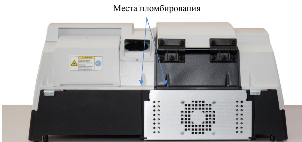
Рисунок 3 – Схема пломбировки от несанкционированного доступа спектрофотометров
