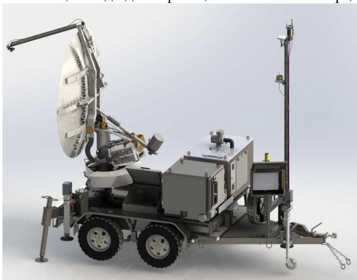
Рисунок 1 - Общий вид измерителей установленных на подвижное шасси
