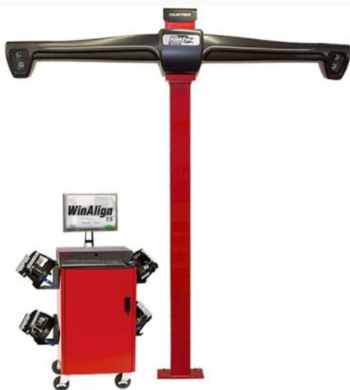
Рисунок 1 - Общий вид устройств для измерений углов установки колес автомобилей с индексами FC, LZ или ML в наименовании модификаций
