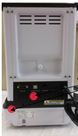
Рисунок 2 – Схема пломбирования от несанкционированного доступа
