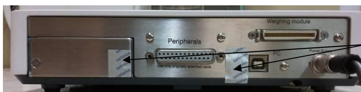
Рисунок 2 - Схема пломбирования от несанкционированного доступа модуля терминала
