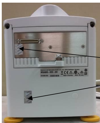
Рисунок 3 - Схема пломбирования от несанкционированного доступа взвешивающего модуля
