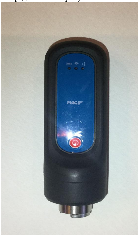
Рисунок 1 – Общий вид виброметров (вид спереди)
