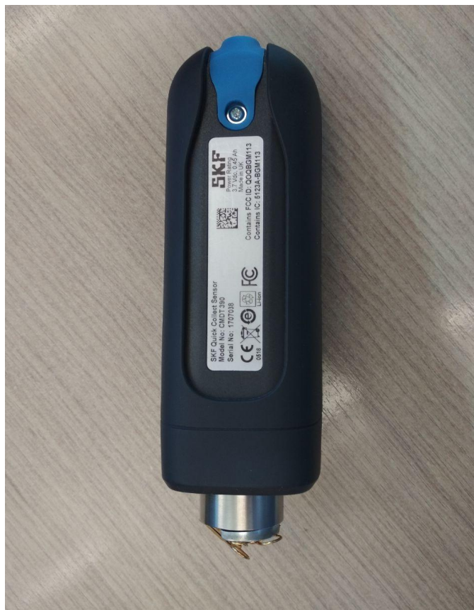
Рисунок 2 – Общий вид виброметров (вид сзади)
