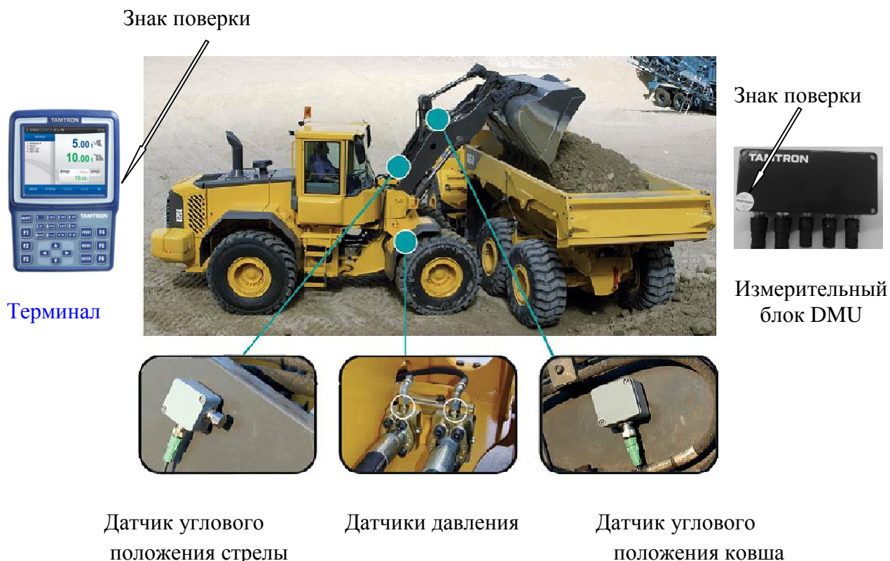
Рисунок 1 - Общий вид терминала, измерительного блока DMU и АВУ с датчиками
