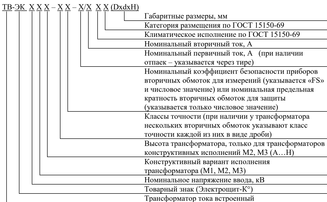
Рисунок 1 – Структура обозначения трансформаторов тока ТВ-ЭК
