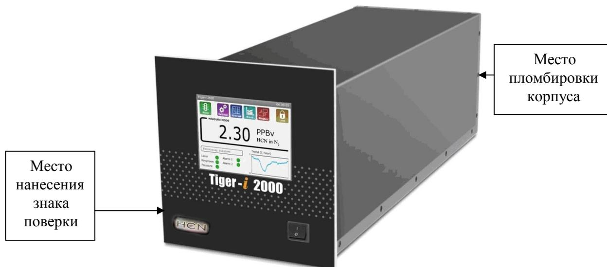
Рисунок 1 – Общий вид газоанализатора
