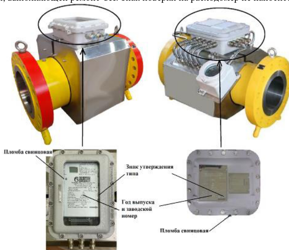
Р и с у н о к 2 – Схема пломбирования расходомеров газа ультразвуковых марки MPU серии С
